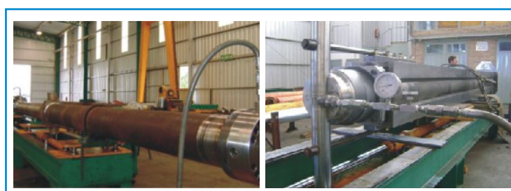
Desarmado, armado y prueba hidráulica de cilindros H&N
