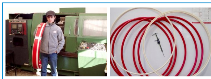
Sellos mecanizados hasta \varnothing 1.500 mm
